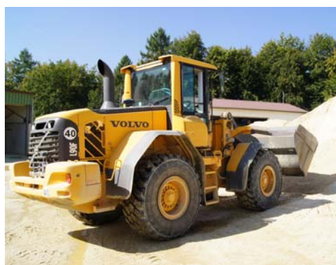
Ist der Radlader mit einem Wägesystem ausgestattet, weiß der Fahrer genau, wie viel Material verladen wird
