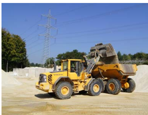
Bei der LKW Beladung muss das zulässige Gewicht genau eingehalten werden
